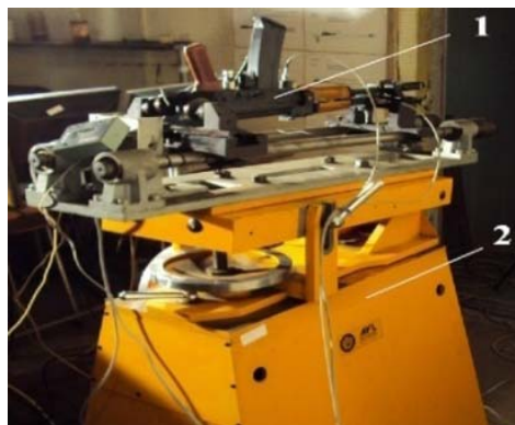
Fig. 10. Fixation de l'arme (1) sur le banc de tir (2)
