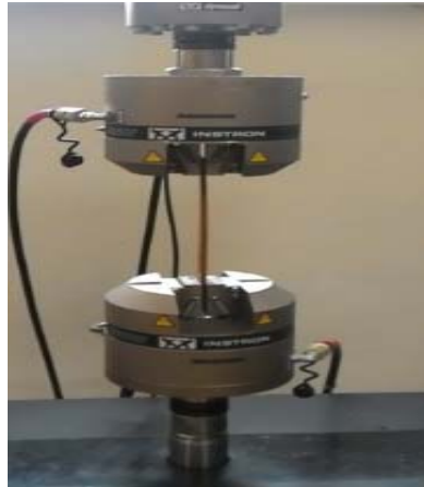
Fig.4. Fatigue test setup
