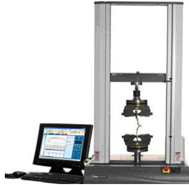
Fig. 1 Dispositif expérimental pour l'essai de traction uni axiale
