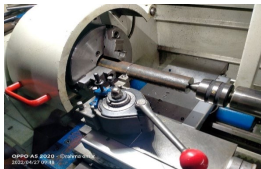
Fig.1. Montage de la pièce usinée sur le tour TURNADO 230/1500V
