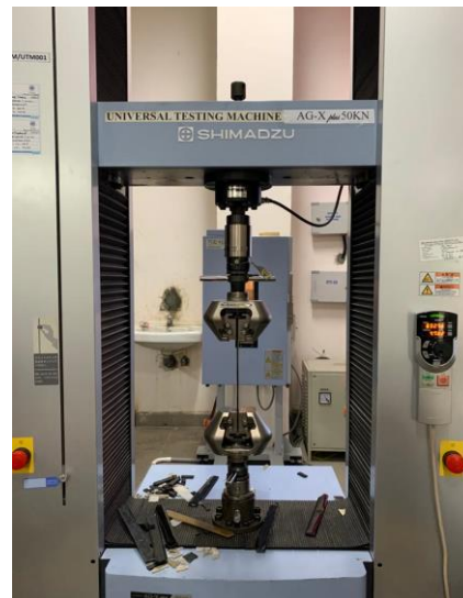
Fig. 2. Tensile test using SHIMAZZU – UTM
