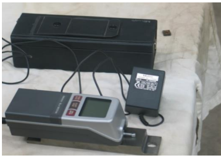
Fig. 1. Rugosimètre Mitutoyo SJ. 201 M
