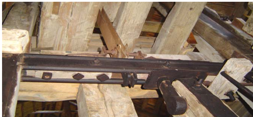
Fig. 2. Coulisse DD' avec deux lame de découpe
